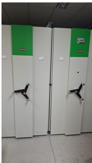
Foto 2 — cabeceiras com a marca London e manípulos de três hastes com trava individual.
